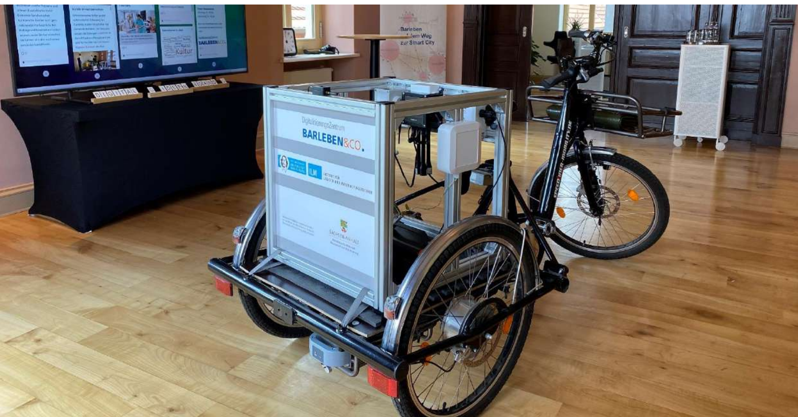
Abbildung 6: E-Lastenrad mit Sensorbox zur mobilen Erfassung von Umweltdaten
